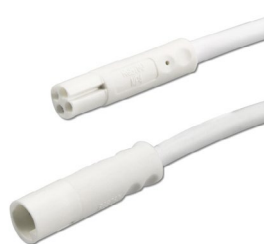
113547 | Mini-Plug RGB Verlängerung male-female, 1m, 4-polig, IP54, weiß, max.
