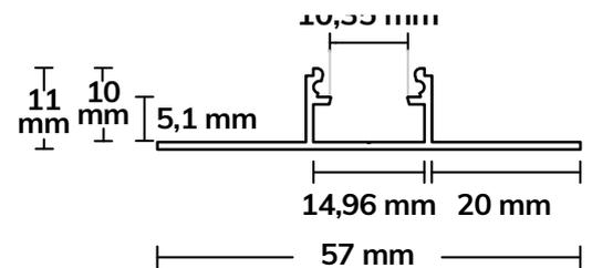
Das Schutzcover wird nach der Montage des Profils in das Alu-Profil zum Schutz eingeklickt. Dadurch, dass es sehr robust ist, hält es dem Druck beim Verspachteln/-putzen oder Streichen stand. Es verhindert, dass Spachtelmasse, Kleber, Dichtmaterial, Silikon oder Farbe in den Innenraum eindringt. Danach wird das Schutzcover abgenommen, gereinigt und ist vielfach wiederverwendbar. Abschließend kann die Abdeckung (PC) in das Profil eingesetzt werden.
