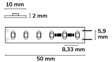
**Hinweis:** CC-Technologie mit zusätzlichen ICs pro Trennstelle an Micro-Lötstellen. Behutsam montieren!
