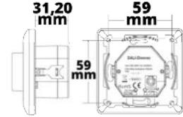
**115058 | DALI DT8 CCT 1 Gruppe Einbau-Dreh Master-Controller, weiß, 230V AC oder DALI-Bus Spannung**
